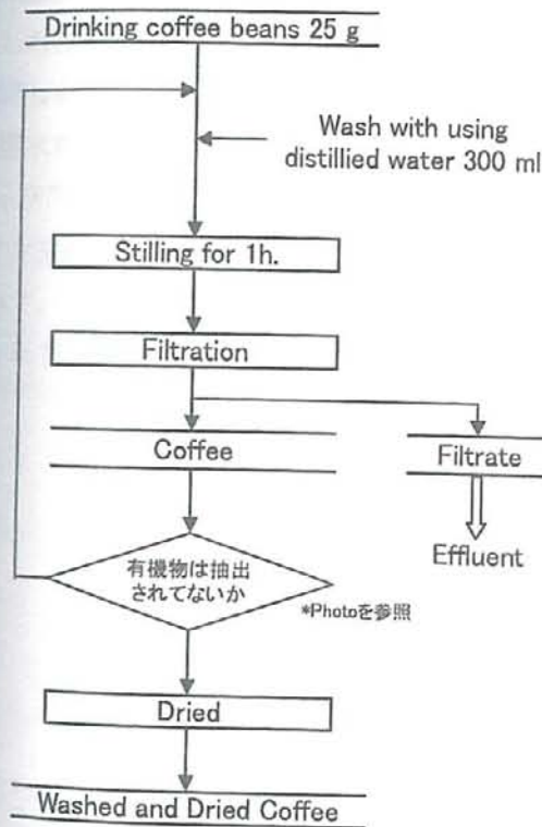
Fig. 21 水洗乾燥 Coffee 殻の作製
