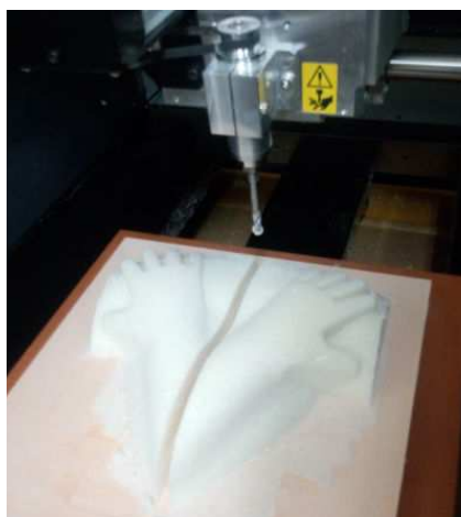
図3 モデリングマシンでの切削様子 (ビリケンさんの両腕を切削)
