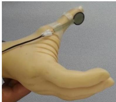
図 B-1-2 義手への取り付け
