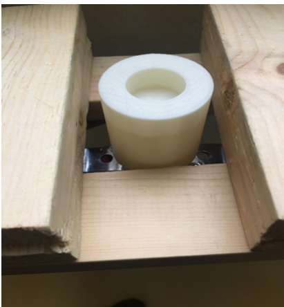
図-6 3D プリンタで作成した接続部
