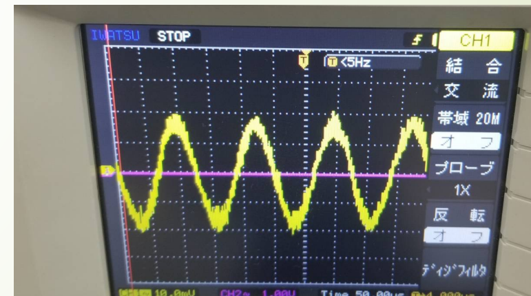
D 中央周波数8Khzのフィルタを通過した電流
